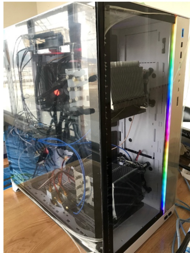
[画像のクリックで拡大表示] 提供するソフトウェア基地局「FW-L5G-1」。一般的なサーバーで動作する (出所：NECネットエスアイ)
