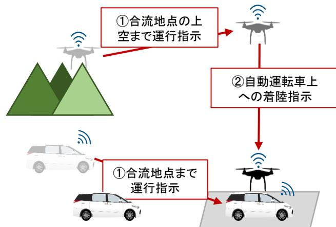
着陸誤差 = クルマの停車位置のズレ + 各PFの座標系の違い + クルマの測位性能の誤差 + ドローンの測位性能の誤差 + ドローンの機体制御性能誤差
