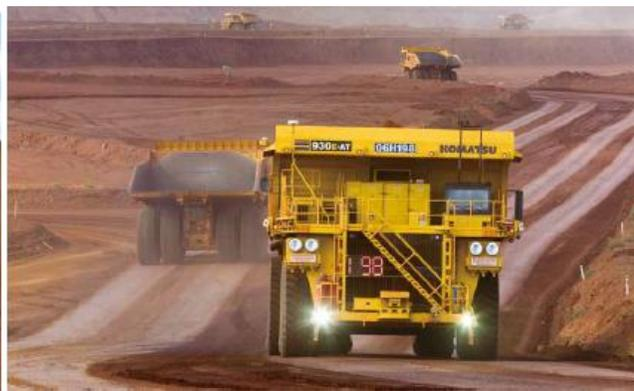
オーストラリアの鉄鉱山で無人稼働する超大型ダンプトラック。鉱山作業の安全性向上、夜間オペレーションの実現などによる生産コストの削減などに貢献。
