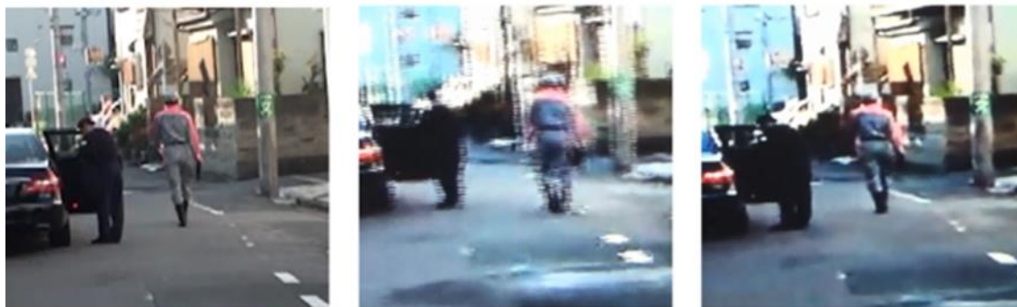
（左図：送信側映像 ／中央図：受信側映像（輻輳状態） ／右図：受信側映像（優先制御）
