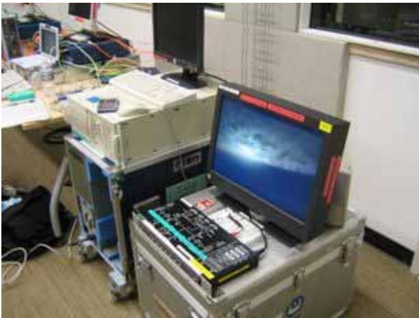
UCSD 設置 NTT 製 ストリーム分岐装置、および、4K 超高精細映像デコーダ
