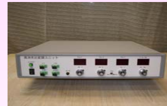
技術移転の例： 高消光比光変調ユニット (特願2005-54209号：超高消光比強度変調方法)
